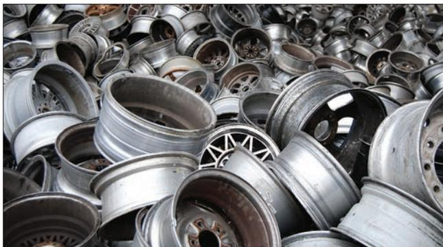
El aluminio se puede reciclar a partir de una amplia gama de productos obsoletos tales como recipientes de bebidas usados, revestimiento de aluminio, radiadores viejos, cables y alambres usados, ruedas de automóviles y de camiones y vehículos y aviones fuera de uso. El ISRI estima que los desperdicios recuperados de aluminio representaron más del 50 % del consumo total de aluminio aparente en los Estados Unidos.
